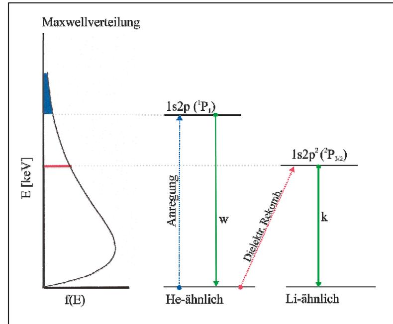
$$\frac{I_k}{I_w} = \frac{\langle \sigma \cdot v \rangle_{dr}(T_e) \cdot Ar^{16+} \cdot n_e}{\langle \sigma \cdot v \rangle_{exc}(T_e) \cdot Ar^{16+} \cdot n_e} = \frac{\langle \sigma \cdot v \rangle_{dr}(T_e)}{\langle \sigma \cdot v \rangle_{exc}(T_e)} \approx \frac{const}{T_e}$$
